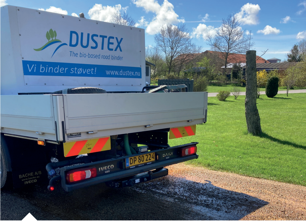
Dustex har en effekt, der både er langt bedre og langt mere holdbar end traditionel vanding. Det binder effektivt støvet, når det sprøjtes ud på grusveje og andre områder plaget af støv. Ved at binde de små og store partikler sammen, får man også en mere stabil vej
